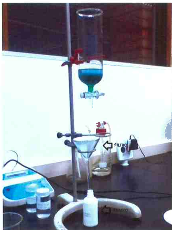
Figura 17. Processo de colhimento das amostras através de um frasco plástico e com o auxílio de um funil filtrado.
