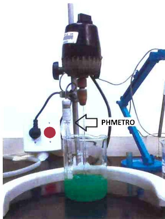
Figura 14. Eletrodo do pHmetro utilizado para medir os ajustes dos pHs da solução aquosa.
