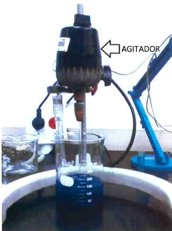
Figura 15. Agitador mecânico usado para agilizar o contato das soluções sintética e orgânica.
